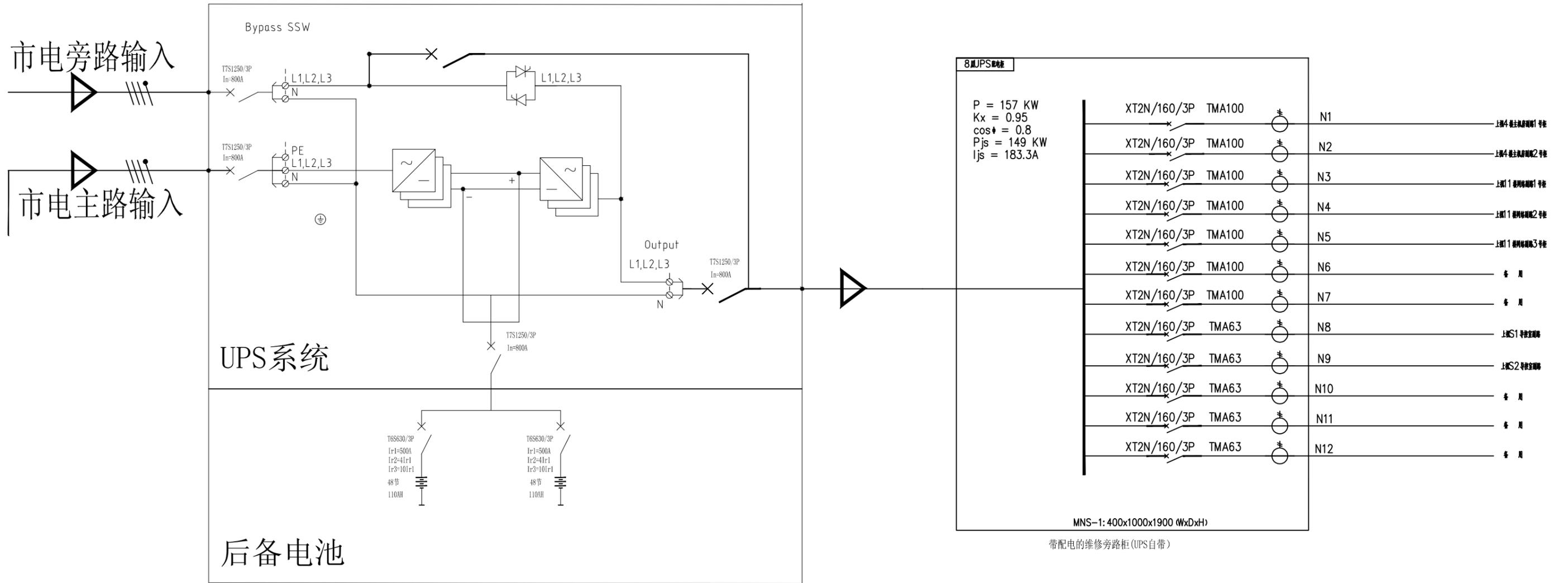
400kVA UPS系统图 (UPS自带)
